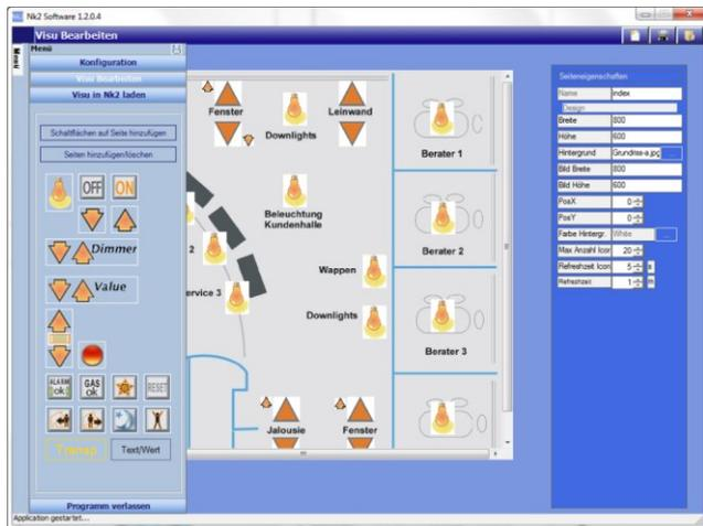
Der Netzwerkoppler NK2 stellt zusätzlich eine Software zur Erstellung eigener grafischer Visualisierungen zur Verfügung.
